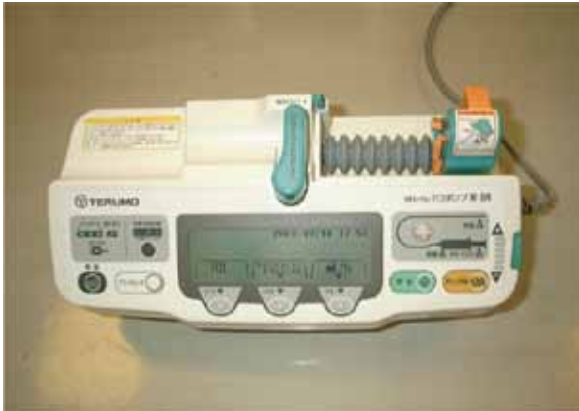
図4. Target Controlled Infusion (TCI) ポンプ 薬物動態モデルをもとに麻酔薬の血中濃度をコンピュータにて推定し、目標とした予測血中濃度を指標としてインフュージョンポンプを制御するシステム
