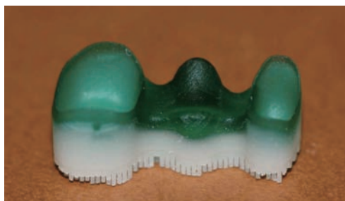
図20. 3Dプリンターによるレジンパターンでは高さを揃えるためのサポートがつく（白色のワックス部分）
