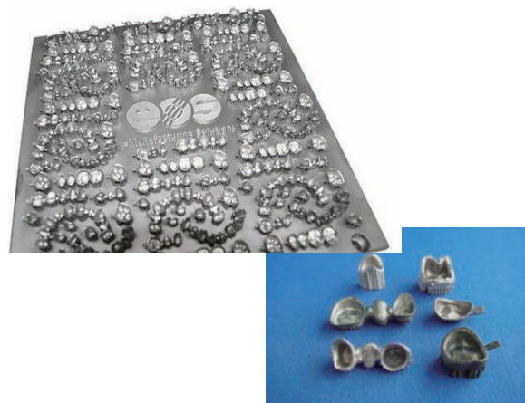
図22. 粉末焼結法によって製作されたメタルコーピング（1回に多数の補綴装置が製作される）
