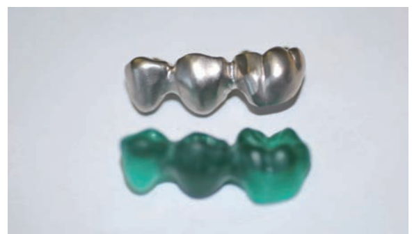
図19. 3Dプリンターによるレジン積層法によって製作されたパターン（下）と鑄造体（上）
